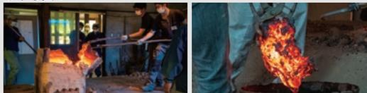
送風管を外し、長い柄のかぎで炉を崩し、鋸（けら）を取り出します。
