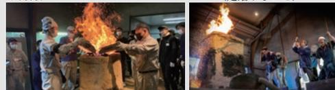
炉に砂鉄と木炭を交互に入れ、「ふいこ」で風を送り砂鉄を溶かします。
